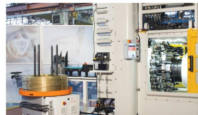
A sinistra: il sistema di alimentazione include una linea di raddrizzatura composta da una serie di rulli che portano il filo all'interno della macchina
