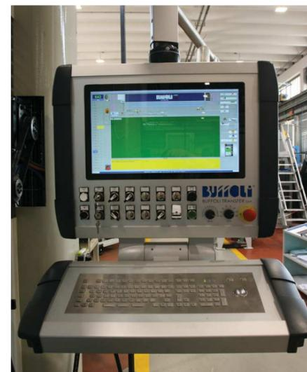
Il controllo numerico è proprietario Buffoli, digitale e multiprocessore, per assicurare la massima reattività della macchina durante le lavorazioni e aumentare flessibilità e semplicità di utilizzo e programmazione
