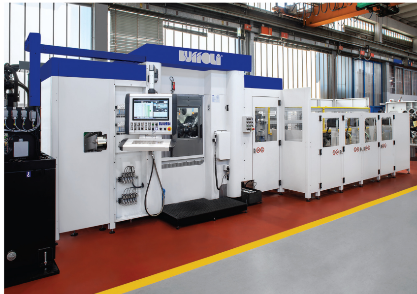
In foto Esempio di Trans-Bar a 12 mandrini CNC per lavorazioni contrapposte
