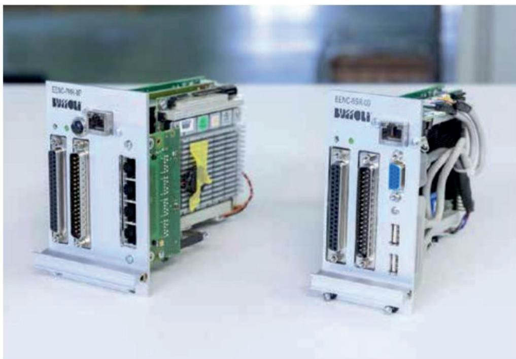
Schede elettroniche CNC controllo assi sviluppate in Electro Engineering
