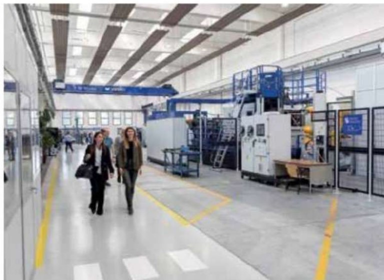
Multi-Way 3D-TG è una macchina a tavola sospesa con 3 direzioni di lavoro per la lavorazione in alti volumi di raccordi in acciaio forgiato
