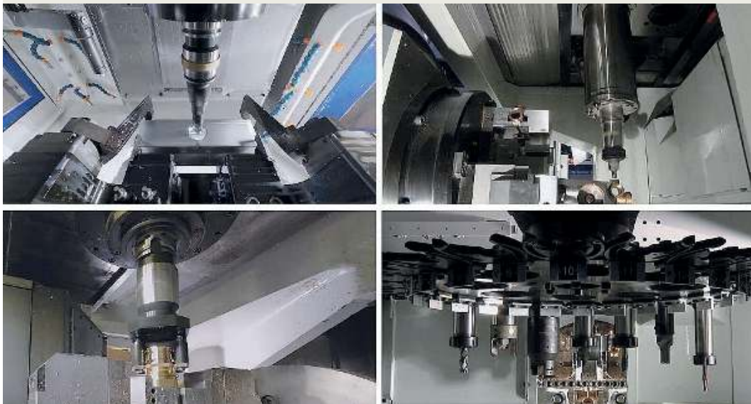
Tecnologia evoluta. Verti-Center di Buffoli Transfer con cambio utensile e serraggi 5 assi o revolver per la produzione flessibile di pezzi complessi
